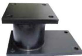
固定ベアリングは、可動部品やアクティブ部品のない計量モジュールの機械的なクローンです。固定ベアリングは、液体の充填レベルを監視する場合に使用できます。ダミーロードセルは、計量機能のない計量セルの機械的なクローンで、ケーブルも含まれていません。これらは、設置段階で計量セルを保護するために使用されます。
