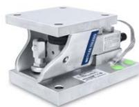
モビリティキットは、多くの業界で一般的な移動式容器の移動中にロードセルを保護するように設計されています。移動式タンク容器やリアクターを安全に移動できるように、ロードセルを取り外した状態で計量モジュールのトッププレートを持ち上げます。ロードセルを衝撃荷重から保護し、移動の前後で一貫した計量性能を維持します。
