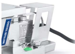
ケーブル保護は、コネクタを機械的な衝撃から保護するため、危険場所に設置する場合は必須です。また、ケーブル保護キットは他の場所にも設置することをお勧めします。これによりタンクスケールの操作の安全性が向上し、意図しないコネクタの損傷があった場合に不要なダウンタイムを防ぐことができます。
