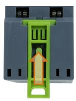
Pour retirer le transmetteur ACT350, il suffit d'insérer la lame du tournevis dans le loquet, puis d'appuyer dessus.
