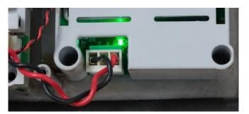
Figura 5-7: LED de 12 VCD en la alimentación de energía
