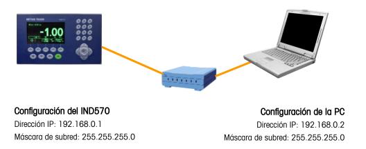
Figura C-1: Ejemplo de configuración de dirección IP
