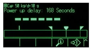
Figura 3-6: Retraso de encendido mostrado en la línea del sistema
