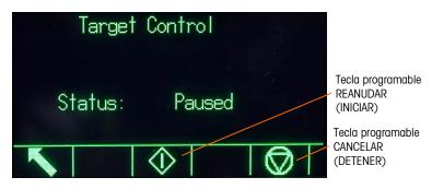
Figura 2-21: Ejemplo de condición pausada en el control de objetivo
