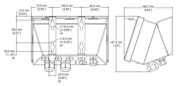
Figura 1-6: Dimensiones de la caja para ambientes adversos del IND570 con soportes de montaje de ángulo fijo, montaje VESA
