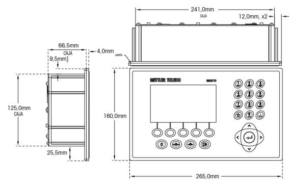
Figura 1-3: dimensiones de la caja de montaje en panel del IND570
