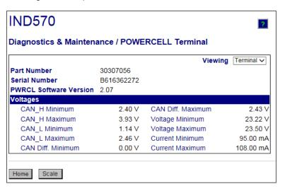
Figura 5-35: Datos del terminal POWERCELL
