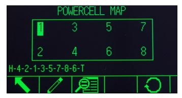
Figura 3-35: Mapa de celdas de carga POWERCELL completado
