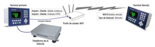
Figura 4-17: Ejemplo de configuración de terminal para función de pantalla remota vía Wi-Fi
