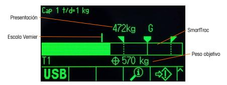
Figura 2-23: SmartTrac de transferencia de material, mediana
