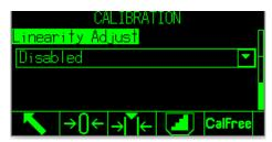
Figura 3-14: Calibración - Configuración del ajuste de la linealidad
