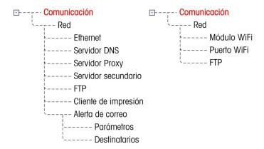
Figura 3-21: Estructura del menú de Ethernet TCP/IP (izquierda) y de Wi-Fi (derecha)
