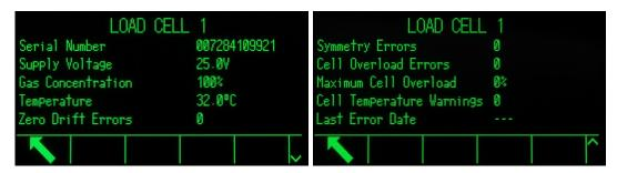
Figura 4-13: Exibição de Detalhe de Célula de Carga
