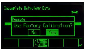
Figura 5-4: Indicación de calibración de fábrica
