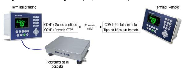
Figura 4-15: Ejemplo de configuración de terminal para función de pantalla remota vía puerto serial
