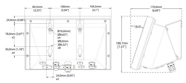
Figura 1-9: Dimensiones de la caja para ambientes adversos del IND570xx con soportes de montaje de ángulo fijo, montaje VESA
