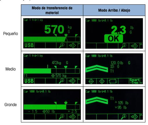
Figura 3-16: Tamaños de visualización, transferencia de material y modos por arriba/por abajo de SmartTrac
