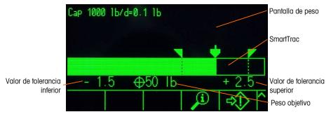
Figura 2-24: SmartTrac de transferencia de material, grande
