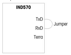
Figura 5-15: Cable de puente entre los terminales de transmisión y recepción
