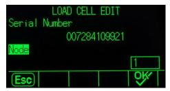
Figura 3-12: Pantalla Editar celdas de carga de dirección manual
