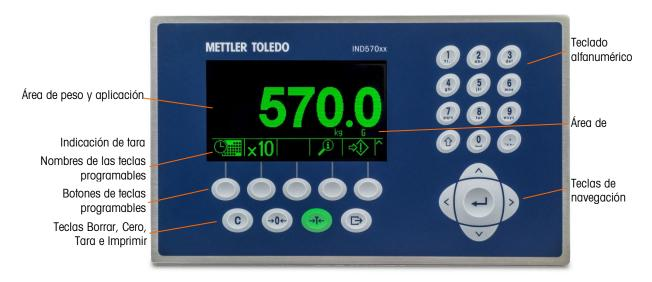
Figura 2-5: Pantalla de visualización y ubicación de las teclas
