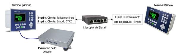
Figura 4-16: Ejemplo de configuración de terminal para función de pantalla remota vía Ethernet
