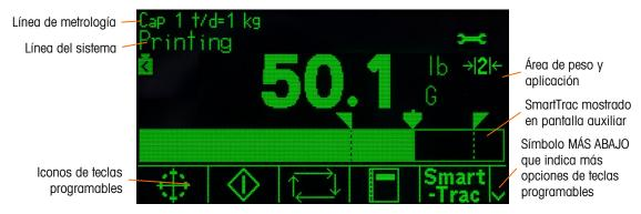
Figura 2-14: Pantalla de inicio predeterminada, línea del sistema con mensaje de impresión mostrado
