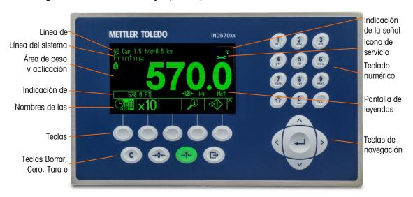
Figura 1-10: Distribución del panel frontal del IND570
