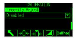
Figura 3-7: Calibración - Configuración del ajuste de la linealidad
