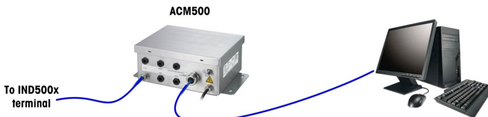
Fig. 130: Connexion avec un câble croisé
