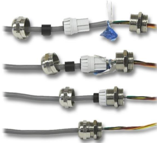
图 5-2: 仪表端的接线屏蔽
