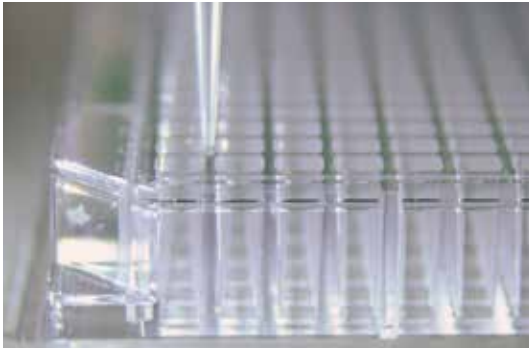
图 A-7: 吸头位于托盘左侧角四个孔之间的正确位置
