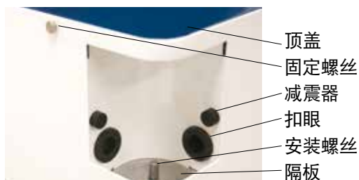
图 1-4: 固定安装螺丝
