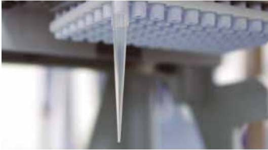
图 A-6: 安装一个吸头
