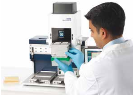
图 1-21: 使用空盒子来支撑移液头部
