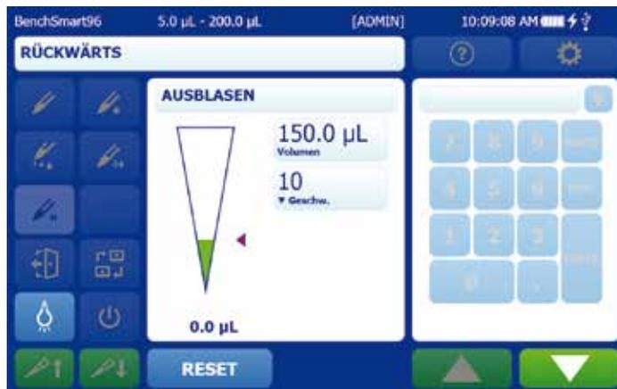
Abbildung 3-34: Der Rückwärtspipettiervorgang wurde angehalten, um das Restvolumen zu dosieren
