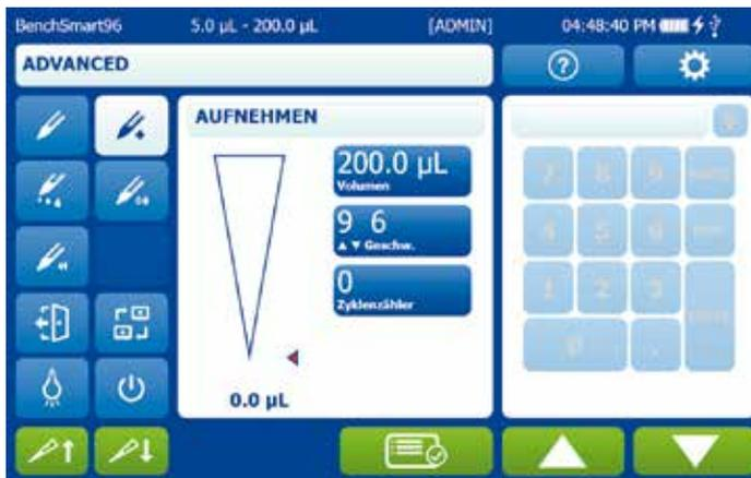
Abbildung 3-12: Auf 0 zurückgesetzter Zykluszähler
