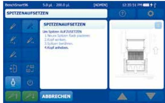
**Abbildung 2-4: Spitzenaufsetzprozess**
