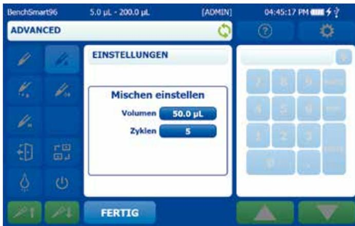
Abbildung 3-8: Einstellen des Mischvolumens und der Anzahl an Mischzyklen
